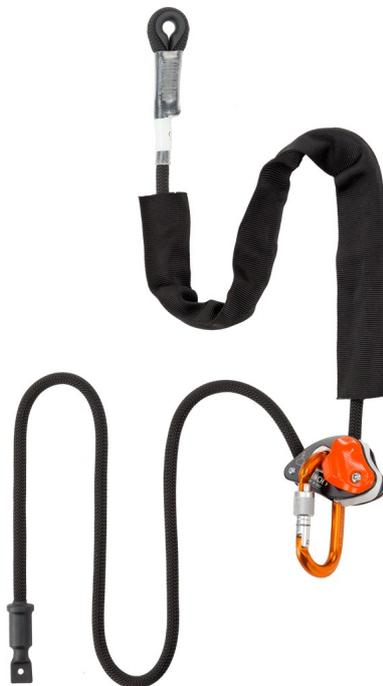
Longe de maintien au travail réglable, compacte, pratique et disponible en trois longueurs différentes (2, 3 et 5 m) sans connecteur terminal. Elle peut être reliée soit aux attaches latéraux (EN 358) d'un harnais complet, pour la remontée de poteaux ou le maintien au travail sur des pylônes, soit à l'attache ventral (EN 813) pour le maintien au travail sur plans inclinés où il n'y a pas de risque de faire un pendule.
